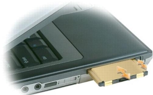
コンピュータはほとんどの PC カードを認識し、自動的に適切なデバイスドライバをロードします。設定プログラムで製造元のドライバをロードするよう表示されたら、PC カードに付属のフロッピーディスクまたは CD を使用します。
