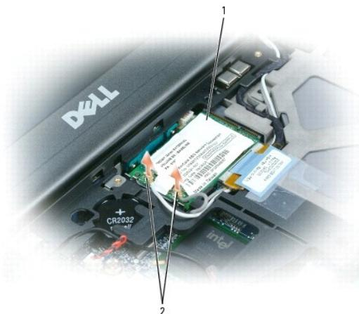
**注意:** コネクタへの損傷を防ぐため、固定クリップを広げるために工具を使用しないでください。
