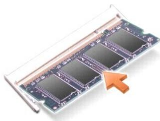
DIMM B コネクタのメモリモジュールを追加または交換する場合は、以下の操作を実行します。
