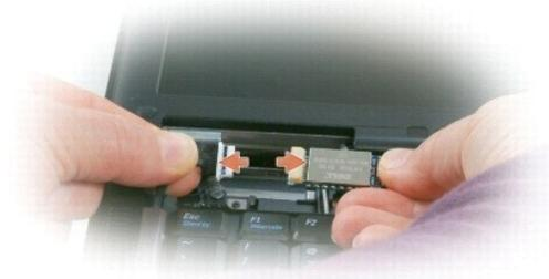
6. ケーブルをカードから外し、カードをコンピュータから取り外します。
